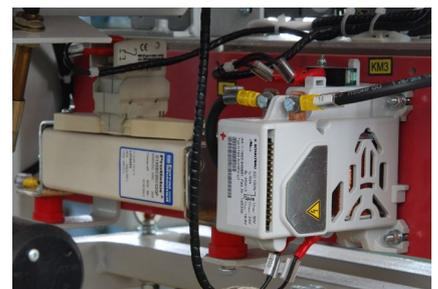
▲ Система измерения сопротивления линии
