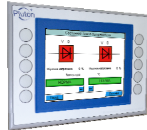
Панель визуализации PP65 системы управления и защит выпрямителя
